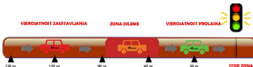
Slika 5. Prikaz zona odluke na prilazu semaforiziranom raskrižju
